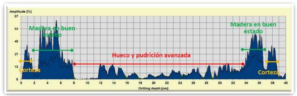
Imagen de la toma y ejemplo de salida gráfica de testificación realizada con Resistógrafo sobre un Ficus macrophylla
