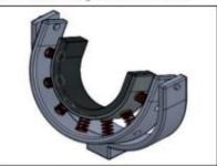
Cana de apoyo oscilante. Permite un contacto directo en perpendicular al tronco y aporta amortiguación para absorber las oscilaciones y el movimiento. Esta parte va inseriada en la cabeta del tornillo de ajuste de la viga telescópica.
