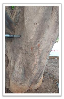
Toma 2: prueba realizada en eje W, a 1,2m, sobre madera viva, orientación E y buscando la zona de madera descompuesta. Presenta todo el resistograma con madera en buenas condiciones.
