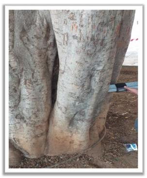
Toma 3: prueba realizada en eje W, a 40cm, sobre madera viva, orientación SE y buscando la zona de cavidad. Presenta todo el resistograma con madera en buenas condiciones salvo unos centímetros (entre el 23 y el 27) con degradación, después vuelve a encontrar madera óptima.
